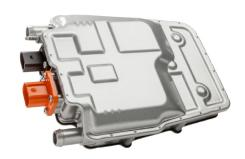
Cet appareil compact fournit une puissance de refroidissement de neuf kilowatts et dispose également d'une fonction de chauffage. Étant donné que toutes les fonctions associées à la gestion thermique (chauffage ou refroidissement) consomment généralement beaucoup d'énergie, Webasto a mis au point une stratégie de contrôle spéciale pour l'ecarry afin d'économiser davantage d'énergie - également en fonction des conditions météorologiques.
