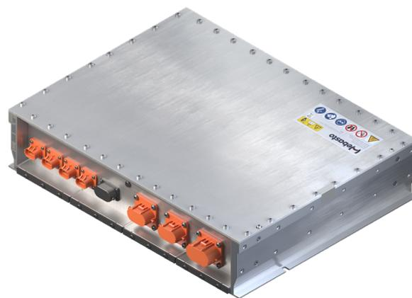
Die Vehicle Interface Box (VIB) ermöglicht die Skalierbarkeit der Batterie und fungiert als effiziente Schnittstelle zwischen mehreren Batterien und dem Fahrzeug. Die VIB vereint die Funktionen von Stromverteiler, Master-BMS und Sicherungen in einem robusten Gehäuse.
